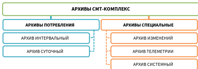
Рисунок 8. Структура архивных данных СМТ-Комплекс
