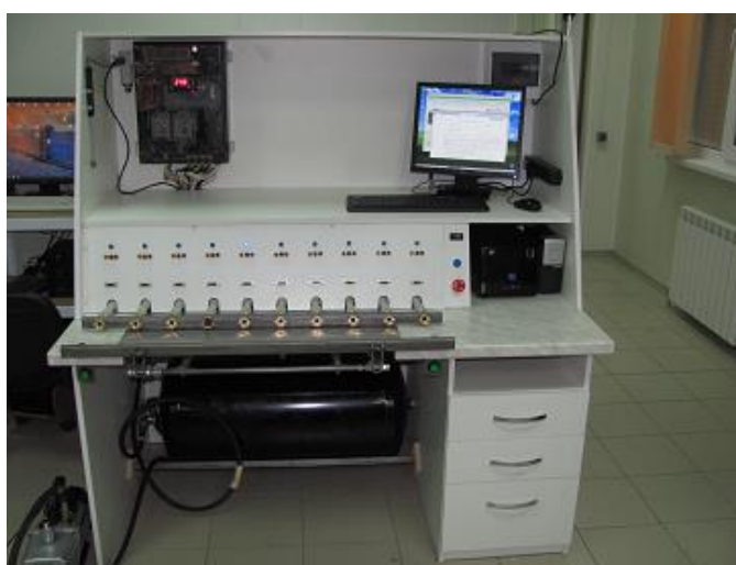
Рисунок 1 - СПУ-5-Х-1 Установка с десятью одновременно подключаемыми счетчиками
