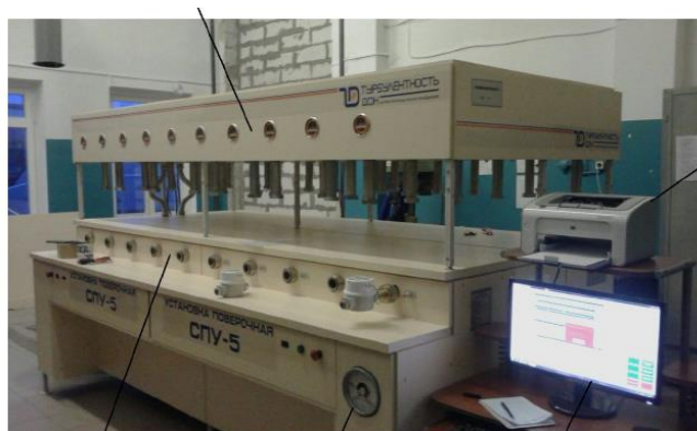
Рисунок 4 - СПУ-5-Х-3 Установка с тридцатью одновременно подключаемыми счетчиками
