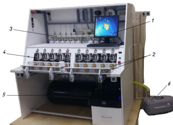
Рисунок 2 - СПУ-5-Х-1 Установка с десятью одновременно подключаемыми счетчиками
