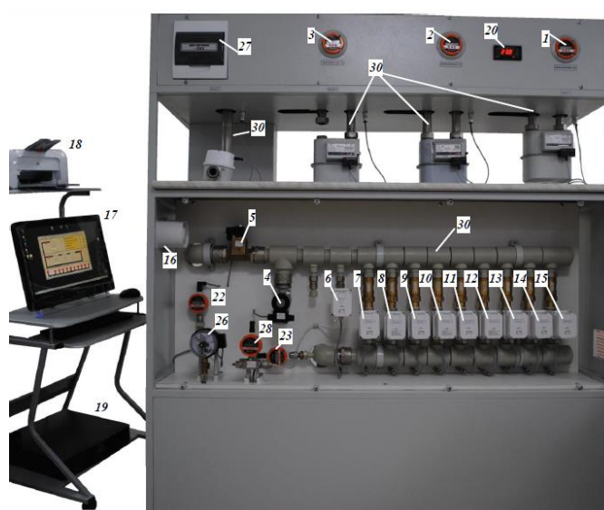
Рисунок 3 - СПУ-5-Х-3 Установка с четырьмя одновременно подключаемыми счетчиками
