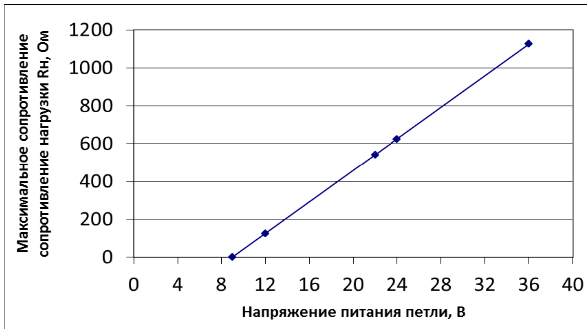
Рисунок Д.1 – Предел допускаемого максимального сопротивления нагрузки в зависимости от напряжения питания токовой петли
