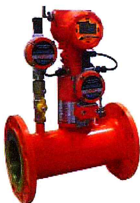
Turbo Flow GFG-F с видом обеспечения взрывозащиты 1Ex d [ia Ga] IIC T4(T6) Gb
